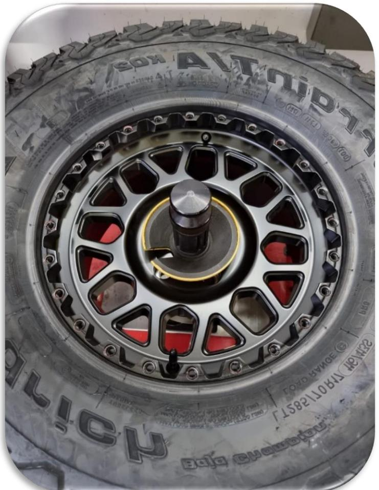
3. **Schrauben Gleichmäßig mit Anti Seize/Keramikpaste** benetzen.
