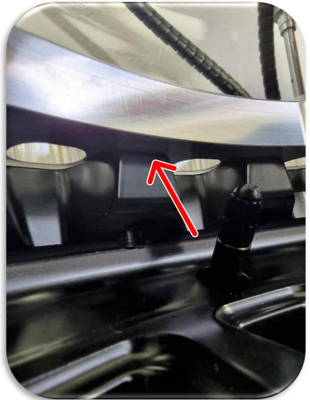
**Achtung nach der Verschraubung muss der Ring Bündig an der Felge Anliegen! Sollte dies nicht der Fall sein setzen sie sich mit uns in Verbindung!**
